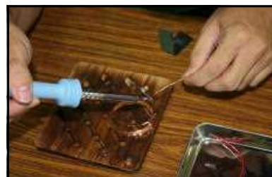
コイルにLEDライトをはんだ付け
